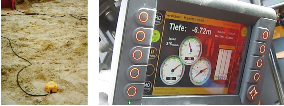
Fig. 9. Monitoring of ground vibrations and display of measurements for machine operator Bild 9. Überwachung der Bodenerschütterung und Anzeige der Messergebnisse für den Maschinenführer
