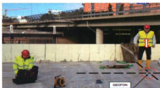
Figur 10. Responsmätning på tre våningsplan under byggnadens uppförande.
