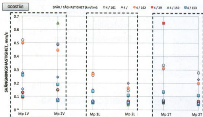
Figur 6. Svängningshastighetens maximalvärden i tre riktningar från godståg på spår 4 (ca. 25 m från spårmitt) för mätpunkt MP 1 och MP 2.
