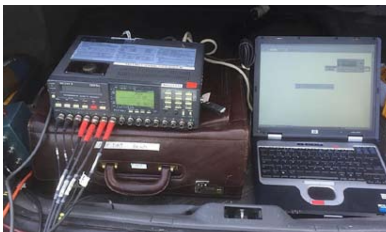
Figur 3. Datainsamlingsenhet, typ SONY DAT PC 216 Ax.
