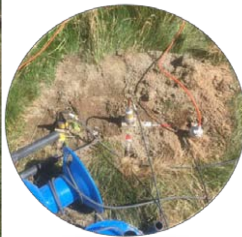
Figur 5. Seismiska mätningar i Åkersberga med triaxiell geofon och triaxiell accelerometer på 4 m avstånd från borrhölet.
